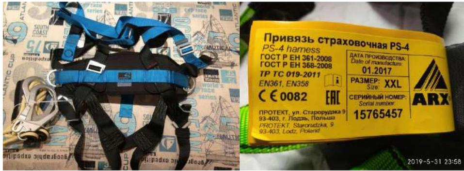
Каждая страховочная привязь имеет свою заводскую маркировку и подробное описание по эксплуатации. В зависимости от сложности модели, снаряжение состоит из определенных составных компонентов.
